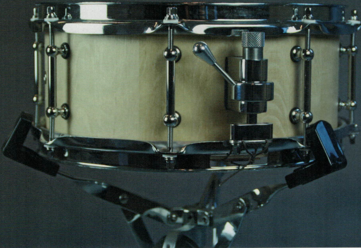
Schlagzeug von Leon Falanga mit Vollholzkesseln in Fassbauweise. Metallteile sind zugekauft
