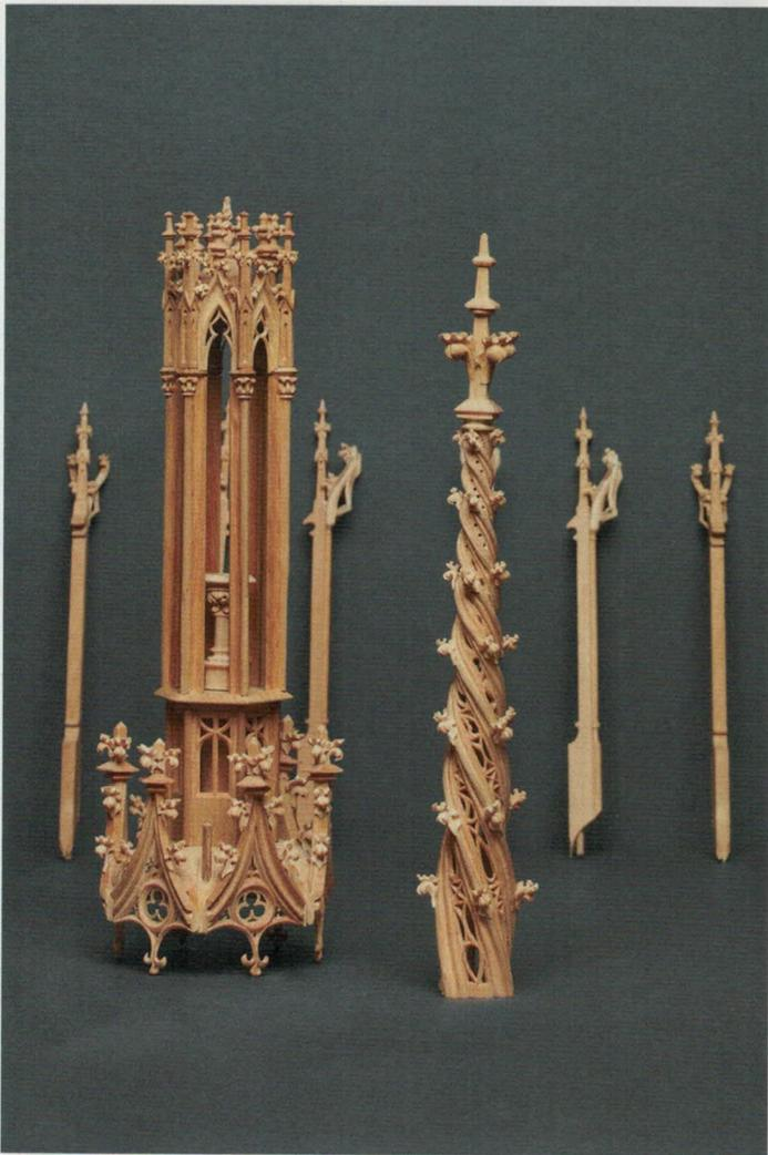
*/ Bewährtes Handwerkswissen: Die gesteckten Strebepfeiler, Fialen und Maßwerk-konstruktionen folgen auch im Holzmodell den statischen Prinzipien des Steinbaus.*
