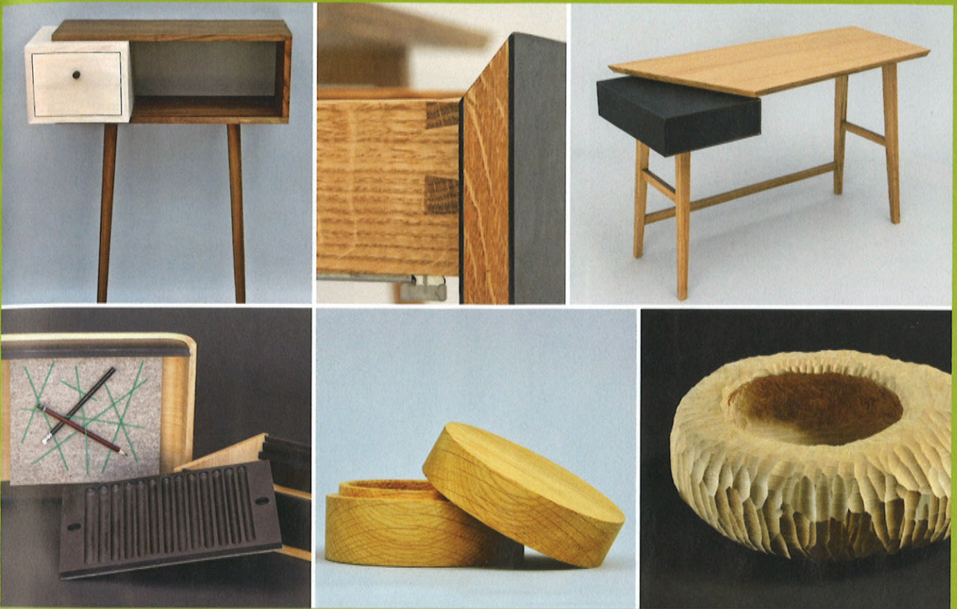
Im Uhrzeigersinn: Schubkasten- möbel aus Nussbaum und Ahorn, entstanden am Ende des 1. Lehrjahres; Schreibtisch aus Eiche, Linoleum und CDF als Zwischenstück; gehauene Schale; gedrechselte Dose aus Eiche; formverleimte Schatulle mit Tablar aus CDF
