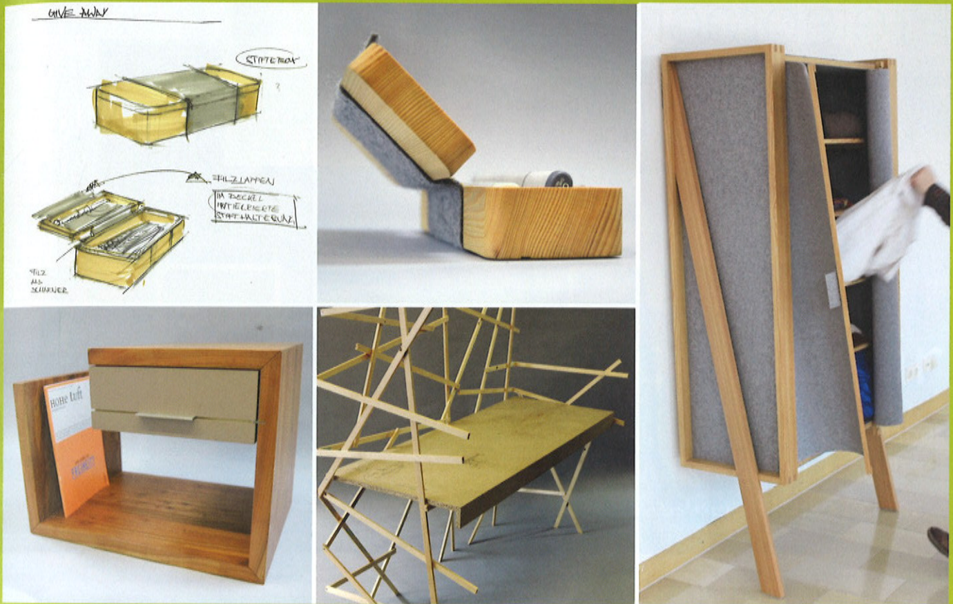
Von der Skizze zum Objekt: Stiftebox aus grauem Filz und Tanne; Projektarbeit Schrank; Ideenskizze Meisterstück; Kleinmöbel Nachttisch, entstanden im 2. Lehrjahr (von links oben im Uhrzeigersinn)
